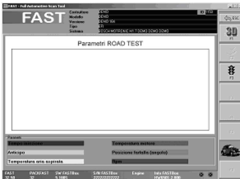
Premendo "F3 START" il fastBOX inizia a memorizzare i parametri impostati precedentemente, a questo punto è consentito all'operatore di disconnettere il fastBOX dal PC o da omniBUS e procedere ad una prova su strada con la vettura.
