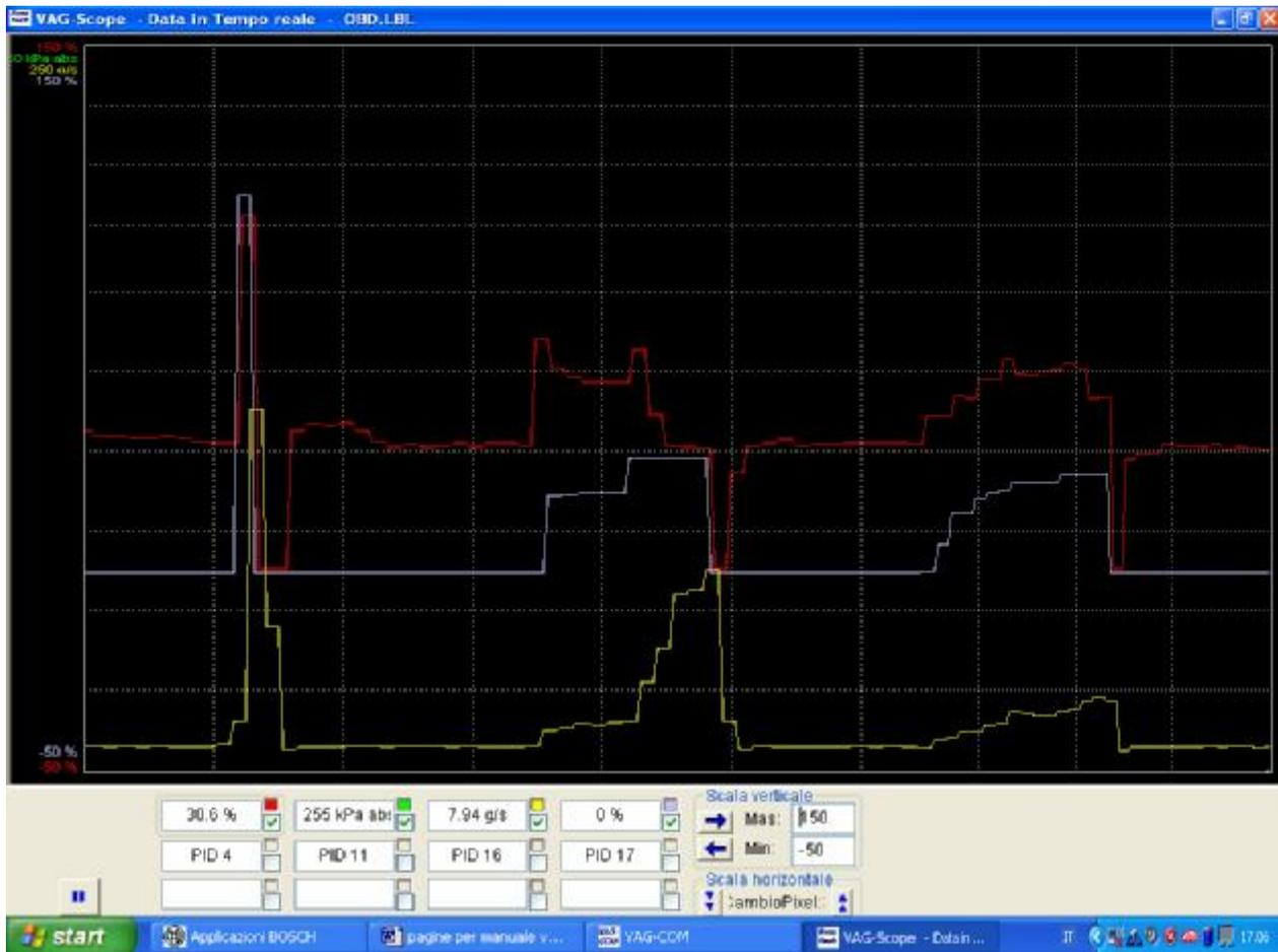
*[VAG-scope] è un collegamento del VAG-COM che permette di rappresentare graficamente le informazioni di un gruppo di misurazione. Vedere l'appendice C per le informazioni su VAG-scope.*
