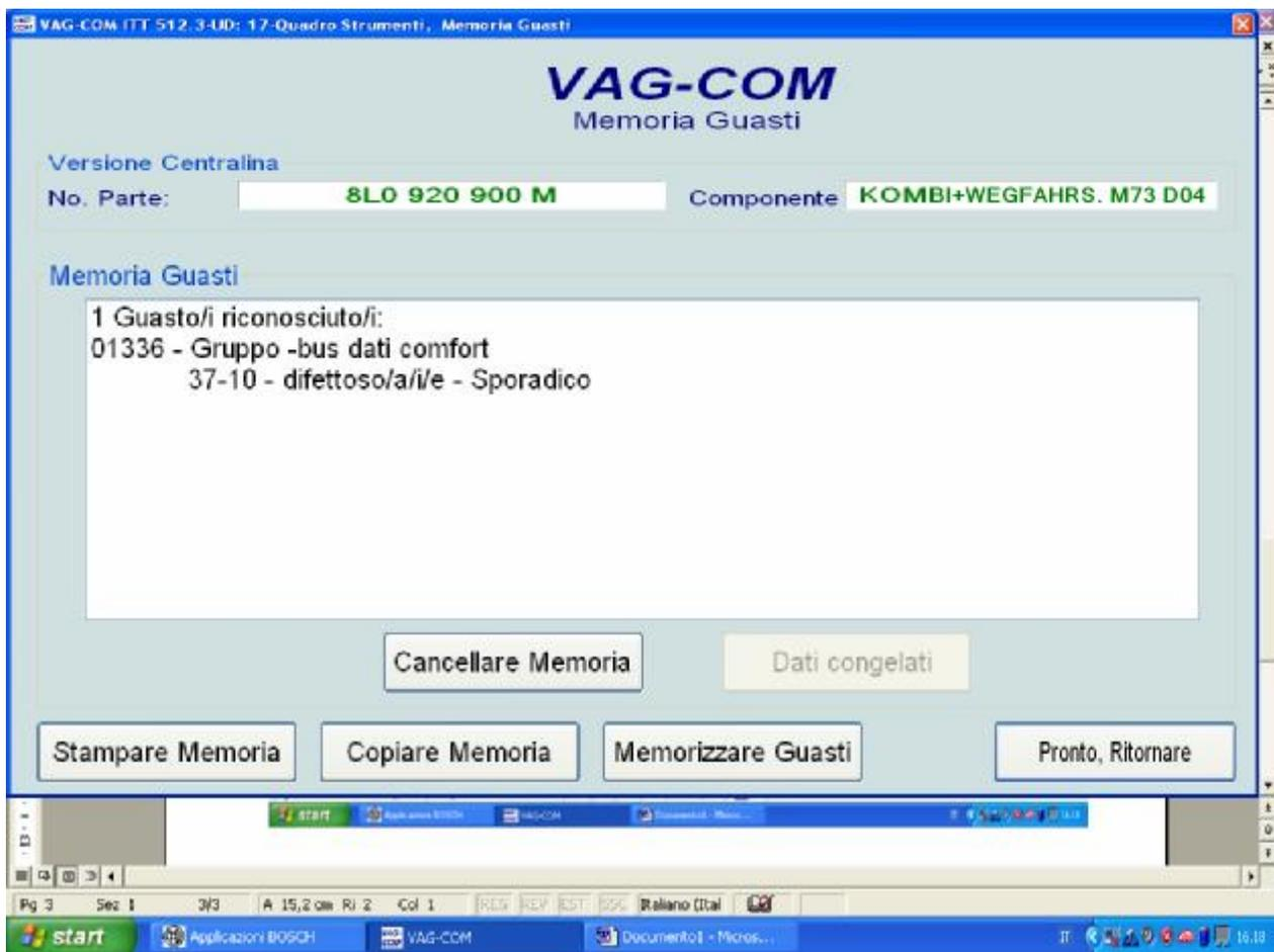
*Questa pagina, mostra tutti i codici di difetto DTC. VAG-COM mostra i codici guasto DTC ed inoltre decodifica ogni codice DTC in testo espressivo. In alto sullo schermo, avete il codice del componente che state diagnosticando.*
