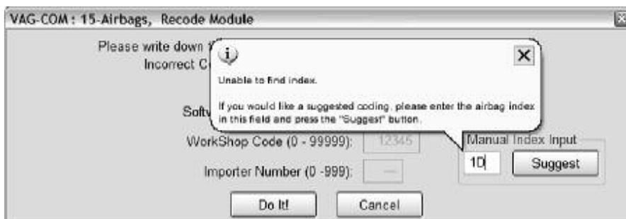
Codifica lunga. Questa funzione è necessaria per ricodificare alcuni moduli di controllo (in particolare Gateway) nei automobili più recenti che usano la linea CAN per sistema diagnostico.
