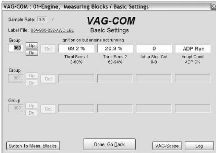
Questa schermata viene visualizzata quando un modulo di controllo è nella modalità di regolazione di base. La modalità di regolazione di base è molto simile ai blocchi di misurazione ed il contenuto di ogni gruppo è lo stesso. La differenza fra le funzioni è che il modulo di controllo in questa modalità può provare a realizzare le varie calibrazioni.
