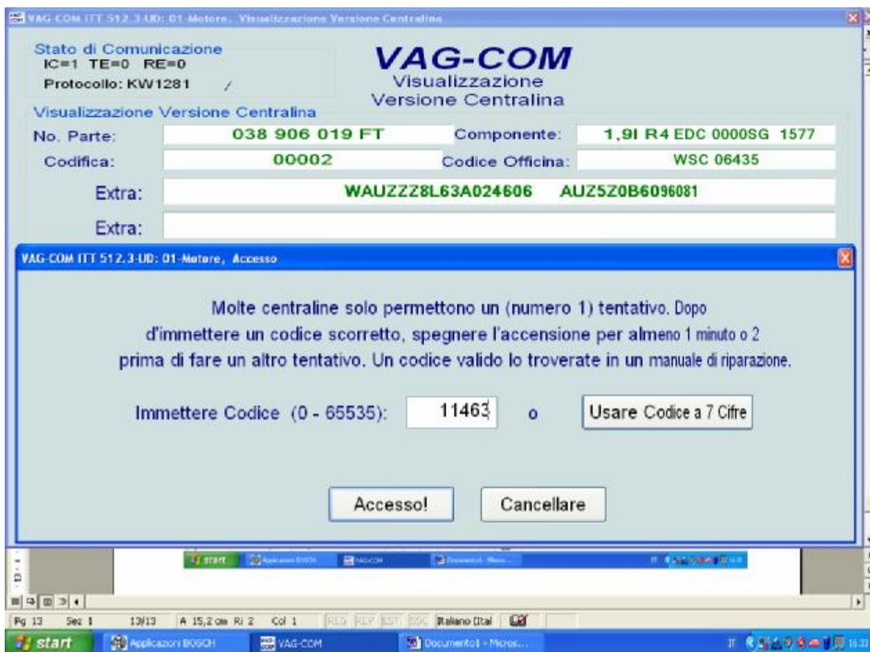
La funzione di accesso di sicurezza deve essere usata su certe (ma non tutte) centraline con protocollo KWP-2000 prima che possiate ricodificare o cambiare i valori di adattamento. Su altre, “permette,, determinate caratteristiche gradite come il controllo di crociera. I codici login validi possono essere trovati nel manuale di riparazione ufficiale.
