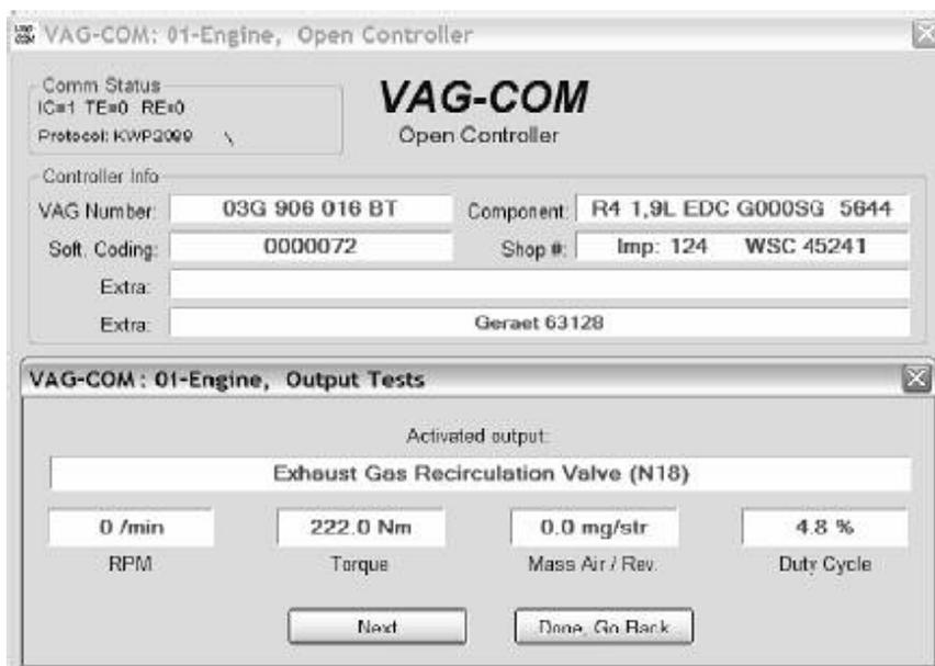
Questa funzione viene utilizzata per verificare le uscite elettriche dal modulo di controllo (ed i collegamenti che la collegano ai vari dispositivi). Le attivazioni con il protocollo KWP-2000 includono i dati di misurazione simultanei se implementati nella centralina in esame. Per cominciare le attivazioni degli attuatori e procedere con il successivo, cliccare [Iniziare/prossimo].
