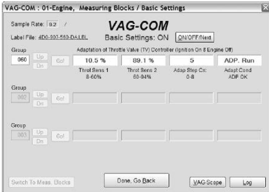
Sulle centraline che usano KWP-2000, c'è un'icona [INSERITA/DISINSERITA/successivo] che vi permette di iniziare o terminare una regolazione di base mentre ancora potete vedere i valori nei gruppi di misurazione.
