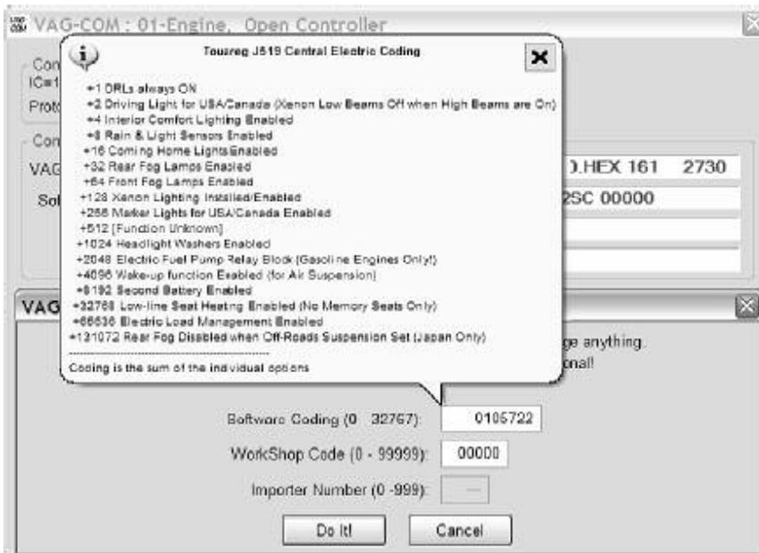
Quando codificate una nuova centralina in molti modelli VW , il VAG-COM può “suggerire,, un valore di codifica adatto.Precisazione: Non possiamo garantire che la codifica che il VAG-COM può suggerire sarà corretta, ma non si dovrebbero provocare danni nel provarla. Se non è corretta, il modulo di controllo rifiuterà semplicemente la codifica e rimarrà a 00000.
