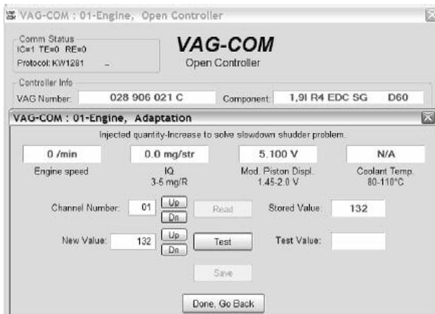
La funzione di adattamento permette di alterare determinati valori e/o regolazioni nelle centraline che le supportano.
